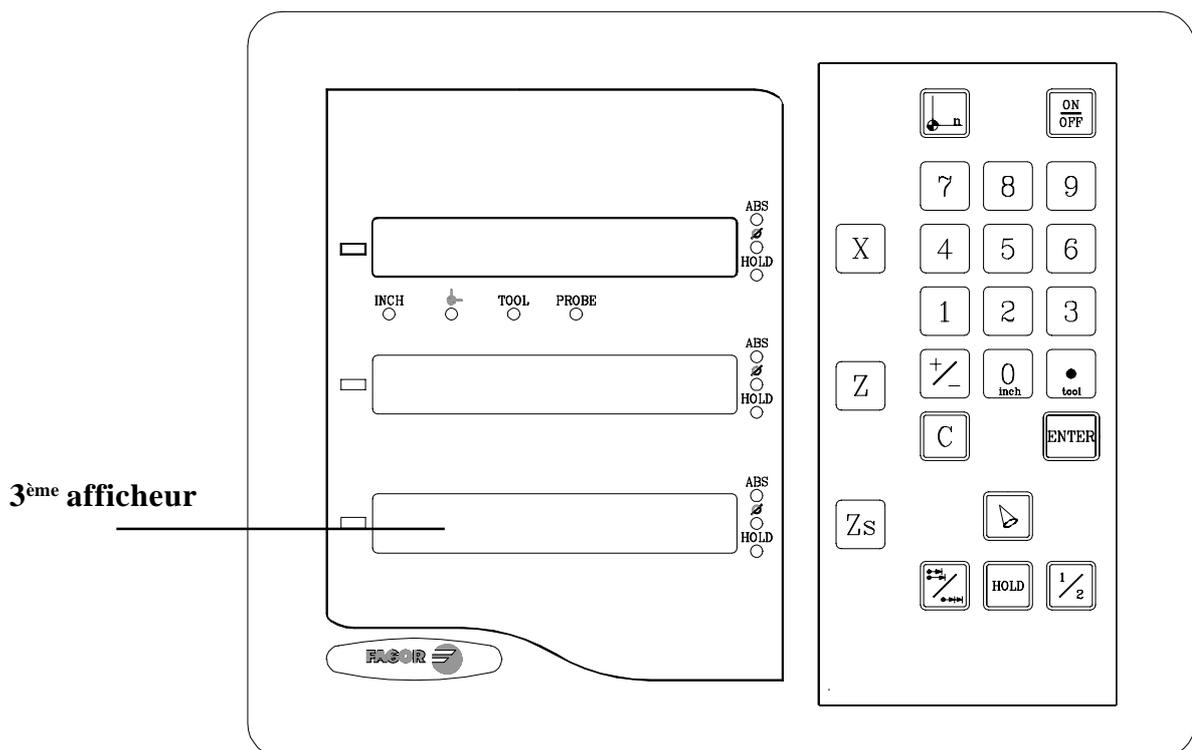
L'afficheur de chaque axe dispose de 8 chiffres verts de 14,1 mm de hauteur et d'un autre pour le signe moins.
