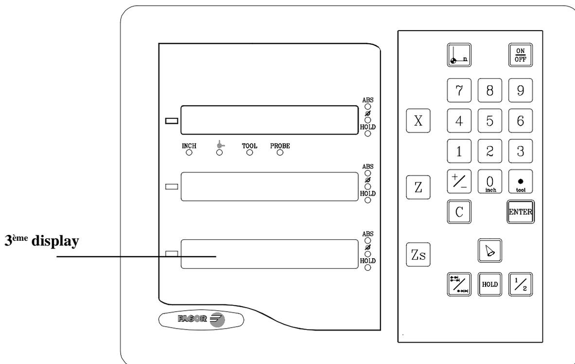
Le display de chaque axe dispose de 8 chiffres verts de 14,1 mm de hauteur et d'un autre pour le signe moins.
